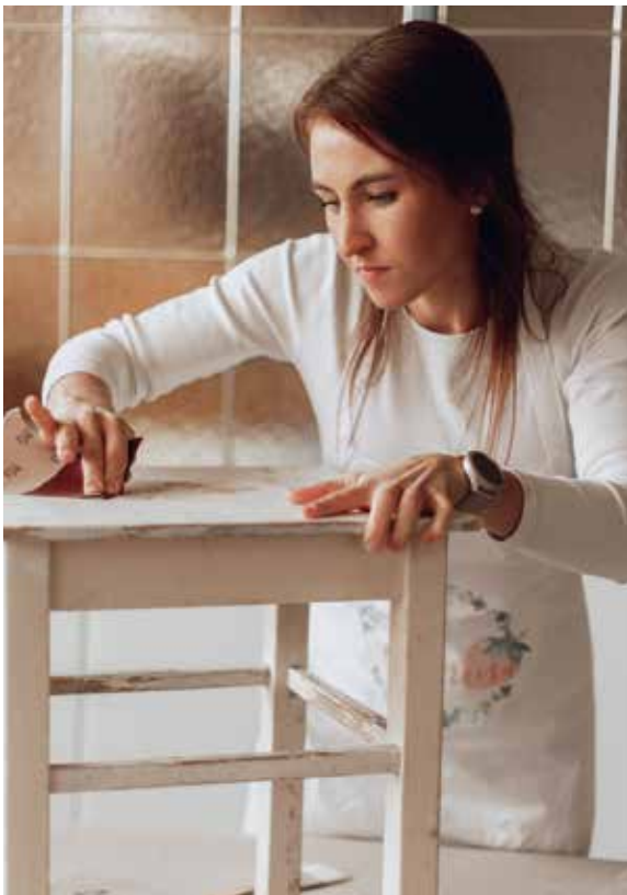
Altlacke, Schmutz und Farbreste müssen vor dem neuen Anstrich entfernt werden.
